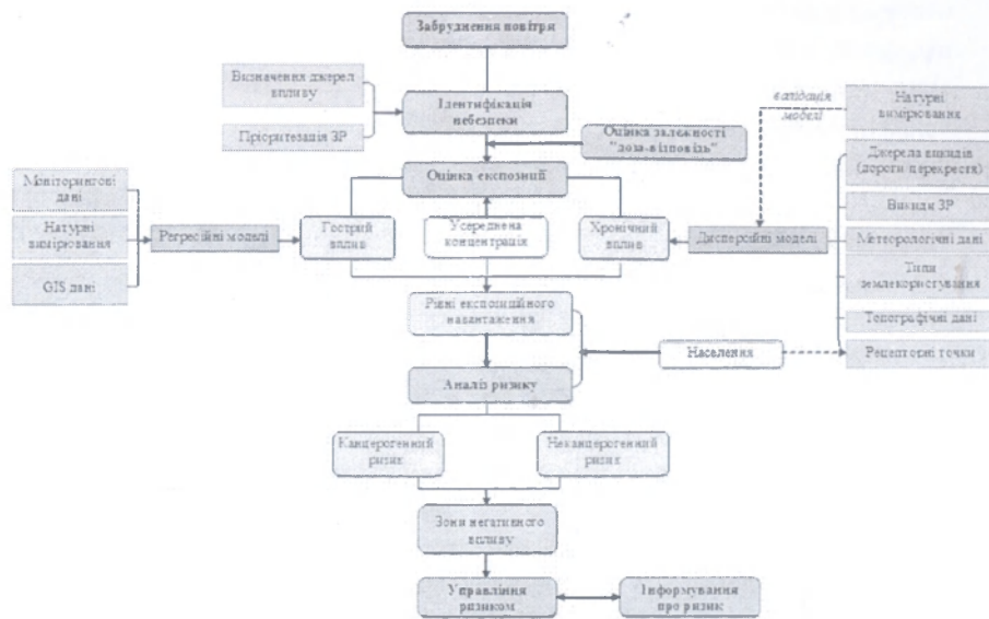
Рисунок 1. Схема оцінки ризику для здоров'я населення від забруднення атмосферного повітря викидами автомобільного транспорту
